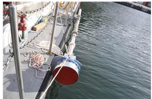
Fig. 3. Multibeam echosounder system (Kongsberg, EM 3001).
